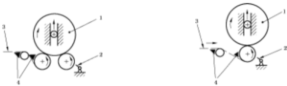
b) 单个主动卷布辊的卷布机防护示例
